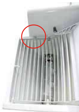
Capteur de sécurité pour arrêter les pales en cas d'ouverture de la grille
