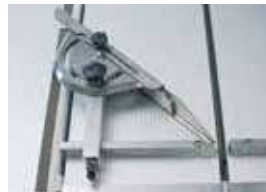
Rappeur d'angle et butée millimétrée coupe à 45°
