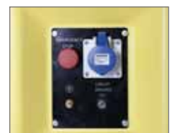
Boîte de commande avec prise de courant de 230 volts.
