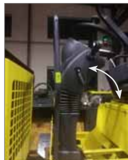
Volant ergonomique ajustable
