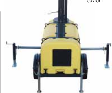
Pieds réglables en largeur et position s'adaptant au sol
