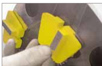
Segments diamantés faciles à remplacer, sans outil
