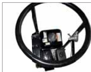
Accélérateur placé au centre sur la poignée
