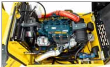
Moteur pour une puissance amplifiée de 44 ch
