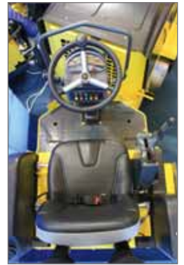
Siège ergonomique antivibratile avec contacteur de sécurité
