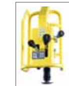
Poignée antivibratile, protection des mains
